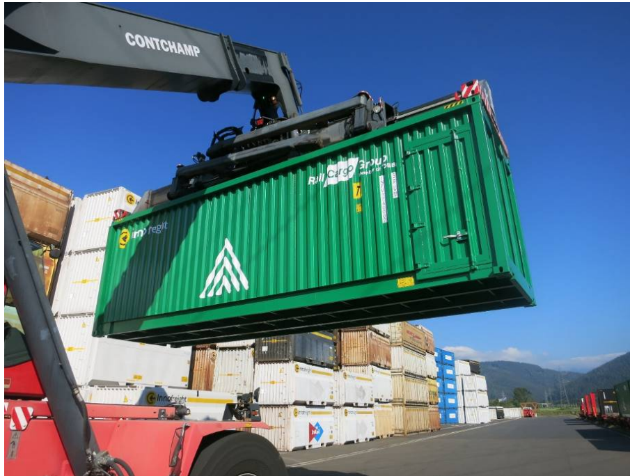
Abbildung 6 Anheben mittels Reachstacker
