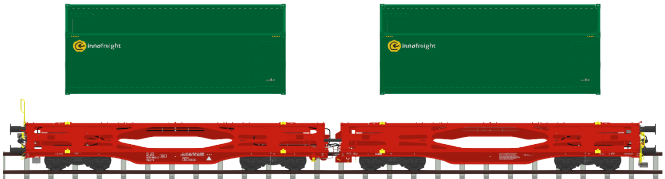
Abbildung 7 Positionierung IW 80ft - Ansicht 1
