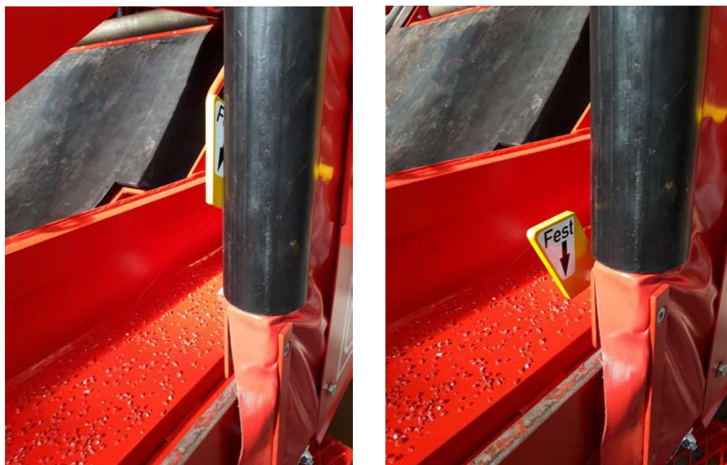
Abb. 4 Planenbremse in geöffneter und geschlossener Stellung
