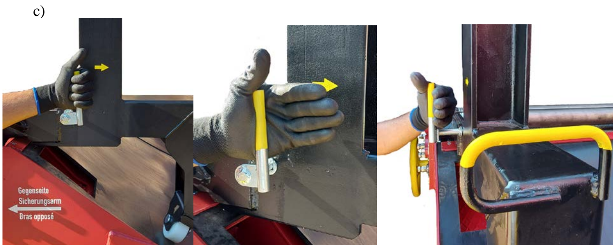
c) „Auf“-Stellung des Hebels (Spindel)
