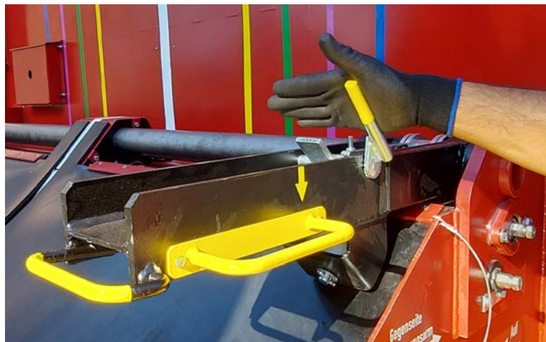
d) Handhabung des Hebels in Pfeilrichtung, an den Armen an der Vorderwand.
