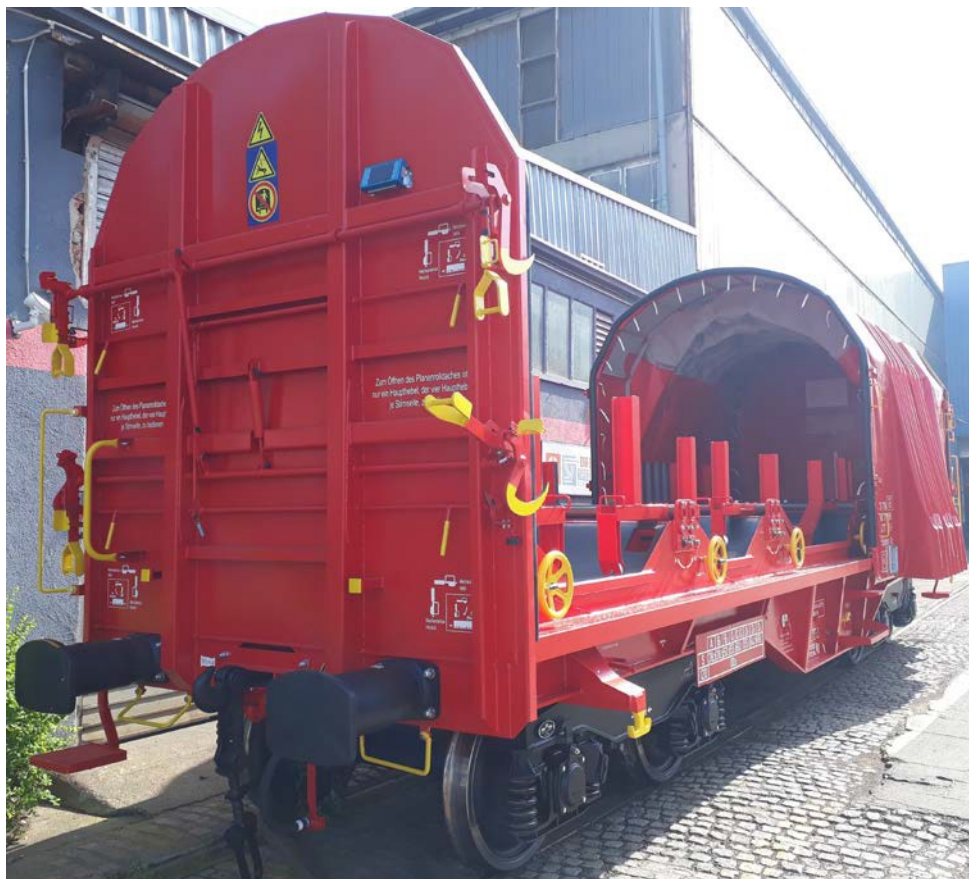
Abb. 3 Plane in geöffneter Stellung
