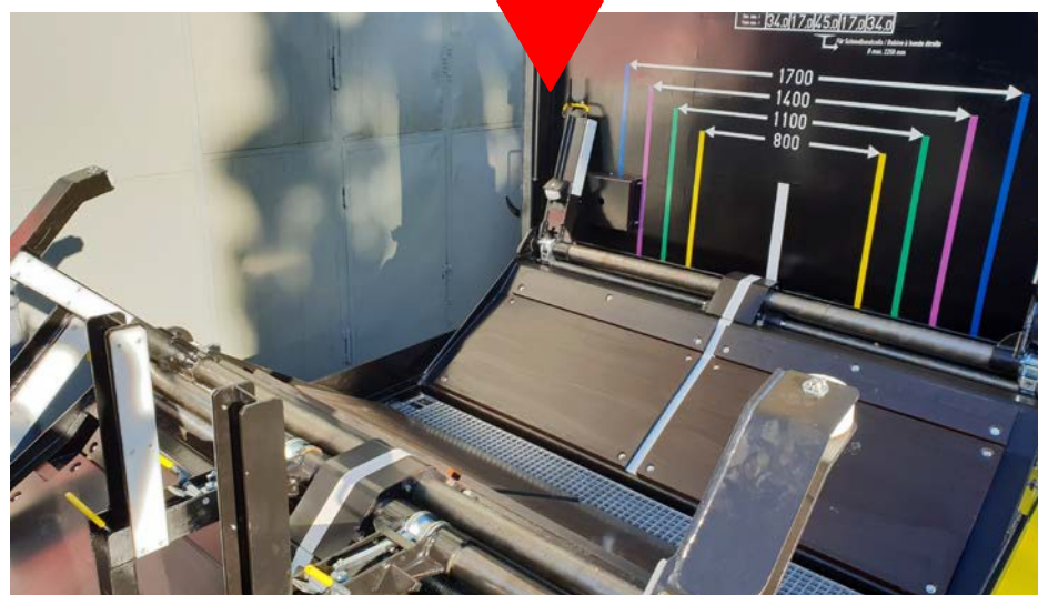
Abb. 14 Arme in geöffneter und geschlossener Stellung
