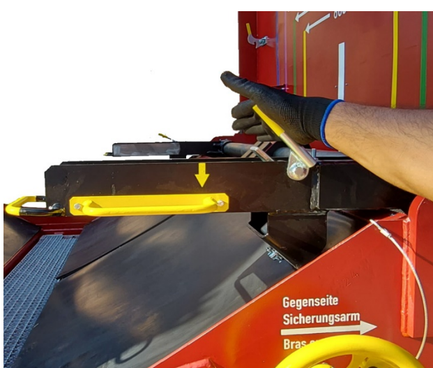
e) Handhabung des Hebels in Position „Offen“ (Spindel)
