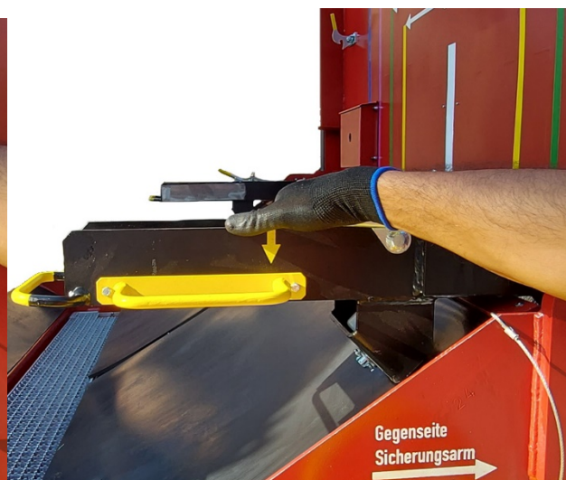
e) Handhabung des Hebels in Position „Offen“ (Spindel)
