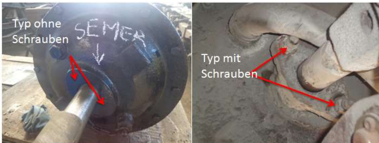
Abbildung 13: Unterschied zwischen beiden Zylindertypen. Links der Typ ohne Schrauben , Kit CYLCD2. Rechts der Typ mit Schrauben, Kit CYLCD3
