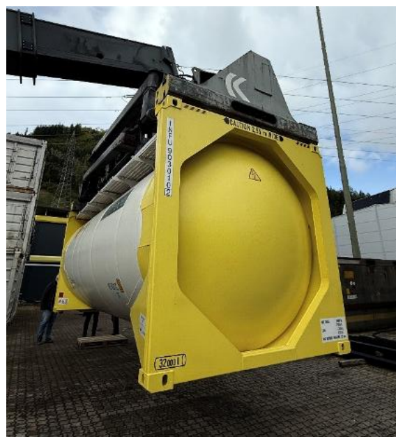
Abbildung 17 Beispiel fürs Anheben - Reachstacker
