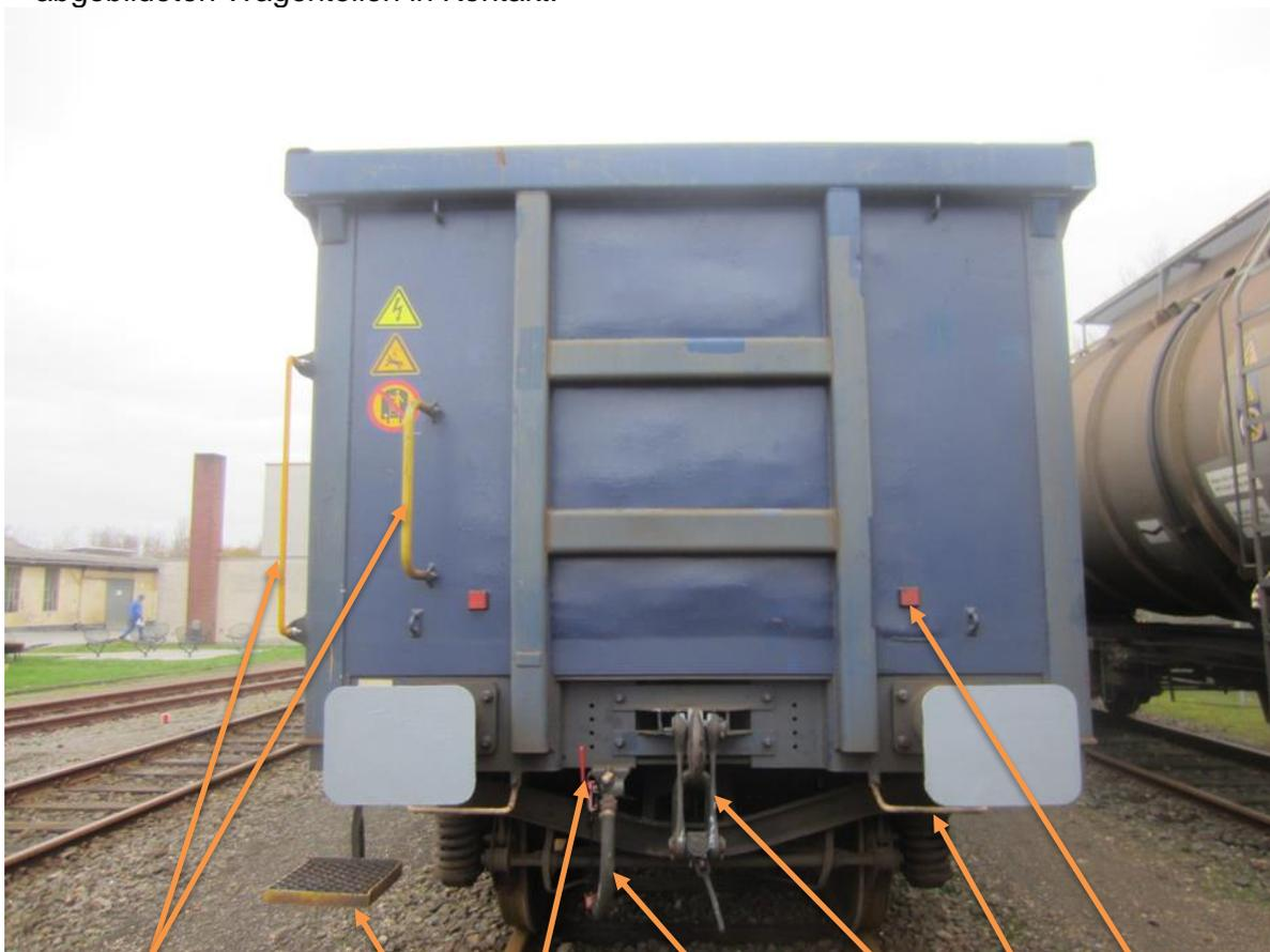
Rangiererhandgriffe Ecktritt Luftabsperrhahn Schraubenkupplung Signalstütze
