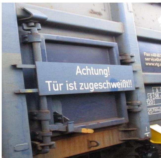
Bild 5.3: Beispiel für die Kennzeichnung einer zugeschweißten Tür
