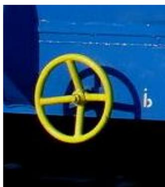
Bild 4.6: Handbremsrad am Untergestell
