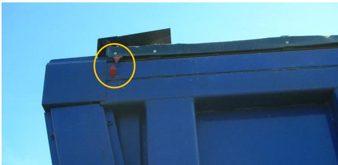
Bild 5.15: Anzeigepfeile ob das Wagendach vollständig geschlossen ist
