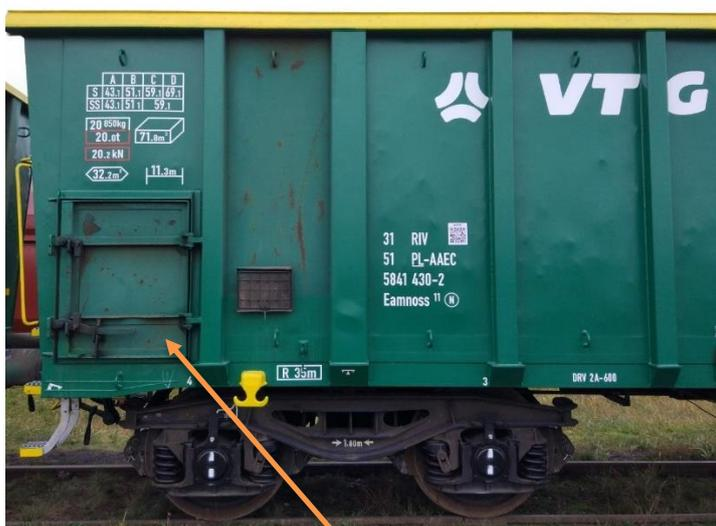
Bild 5.8: Beispiel einer Tür von einer Reinigungsöffnung
