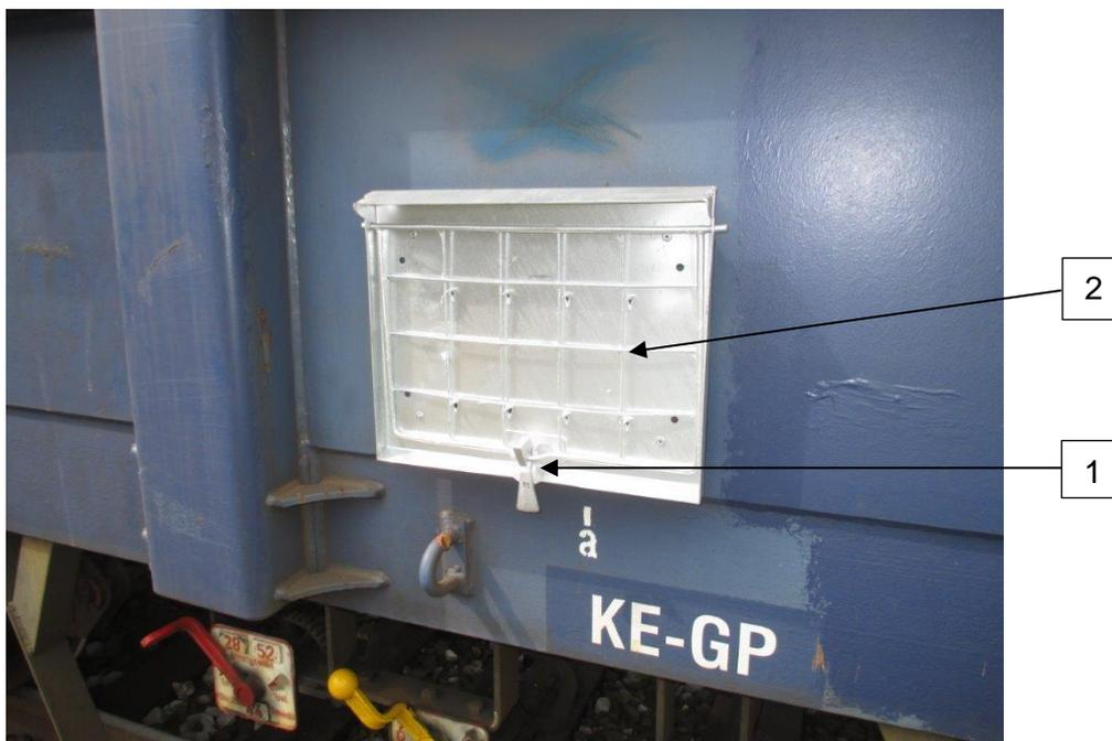
Bild 4.2: Zettelhalter mit Verschlusshebel
