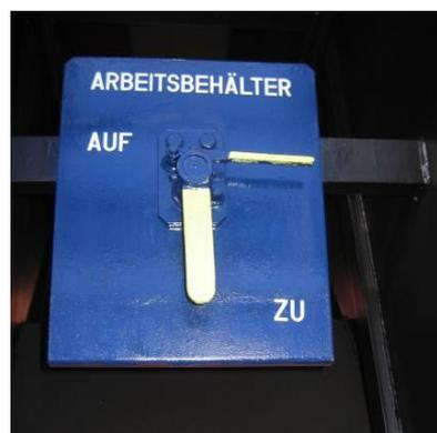
**Abb. 4.2:** Umstellvorrichtung für Druckluftquelle
