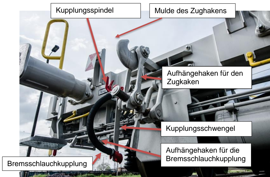
Bild 5.4: Zugeinrichtung
