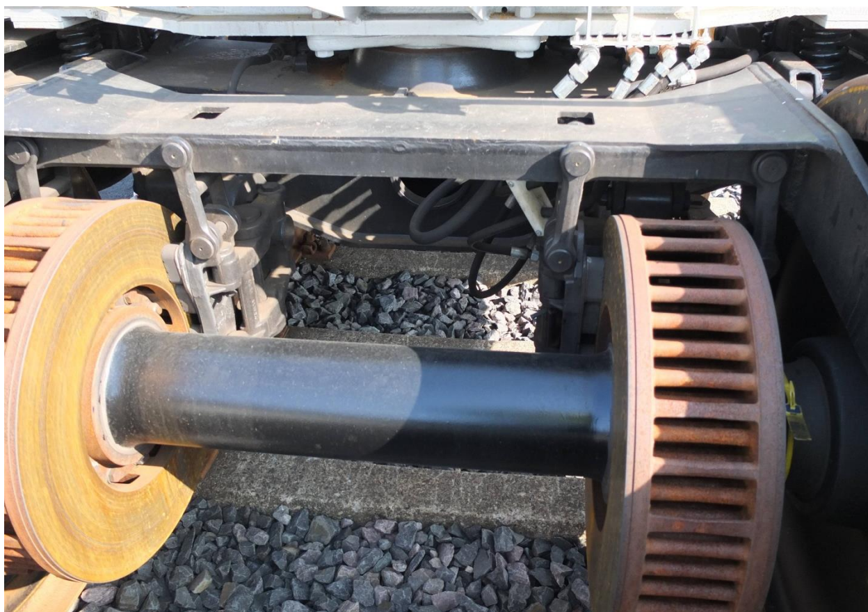
Bild 6.1: Radsatzwelle mit zwei Bremscheiben und Bremsgestängen
