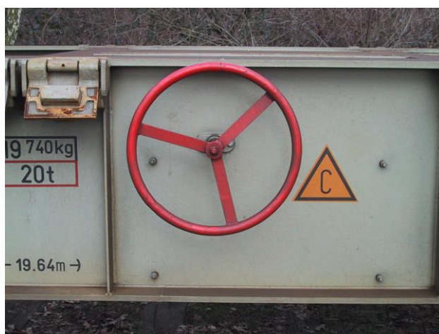
Bild 5.10: Handrad der Feststellbremse
