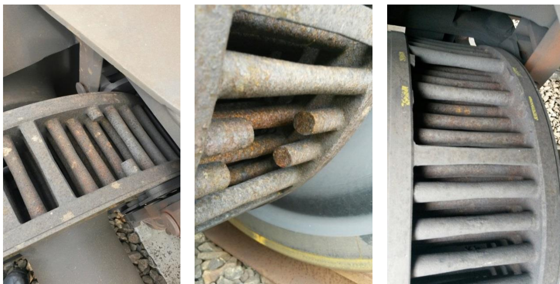
Bilder 6.2 bis 6.4: Wegen Auswuchten gekürzte oder entfernte Kühlrippen.
