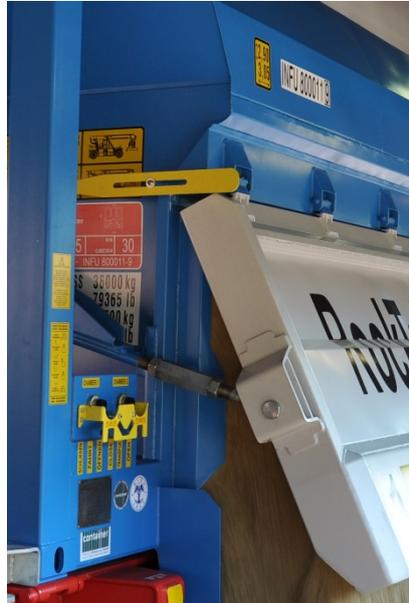
Abbildung 14 Indikator ausgefahren
