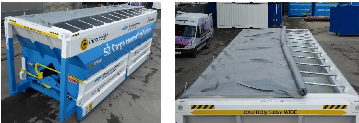
Abbildung 7 RockTainer ORE mit Planendach
