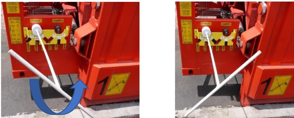
Abbildung 35 Öffnen der Klappen Schritt 2
