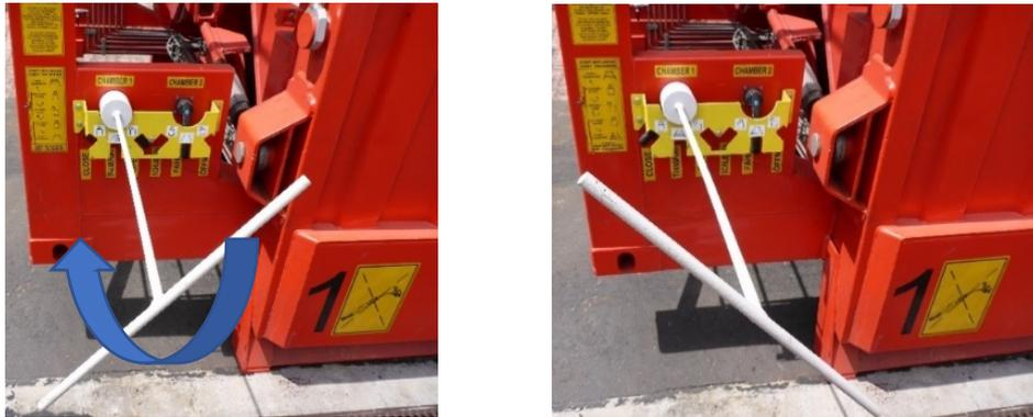
Abbildung 39 Schließen der Klappen
