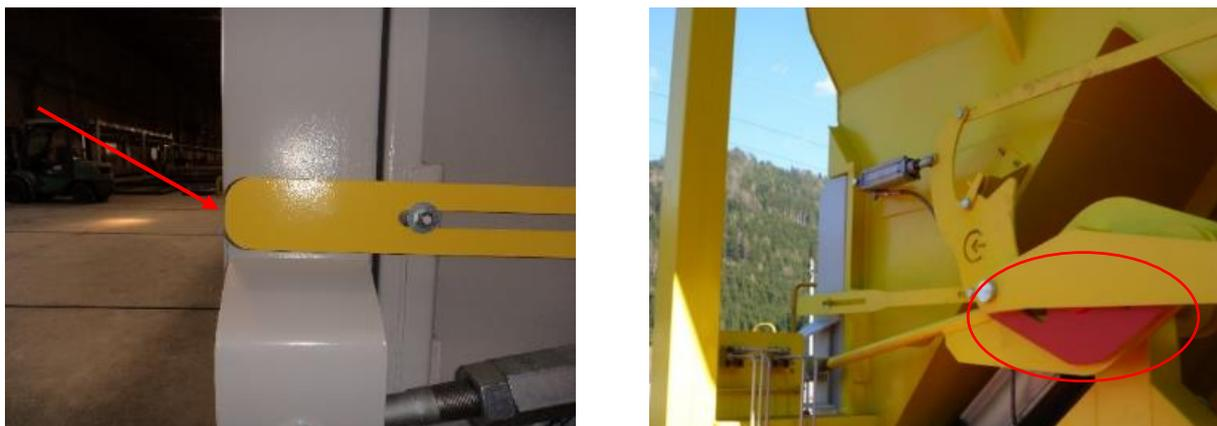
Abbildung 40 Indikator eingefahren & Farbinderikator
