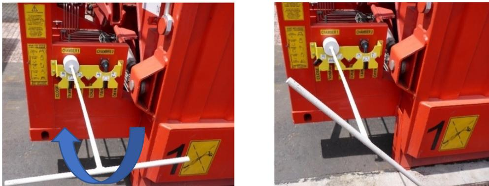
Abbildung 33 Öffnen der Klappen Schritt 1
