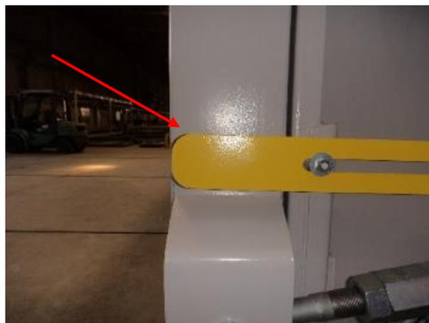
Abbildung 15 Indikator eingefahren
