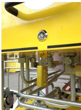
Die Sicherungsbügel sind beidseitig unter Betätigung des Sicherheitsmechanismus zu öffnen.
