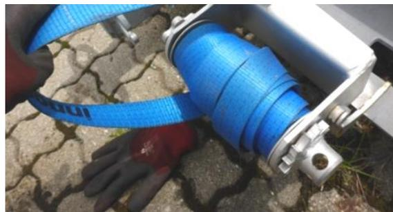
Jenes Spanngurtende mit dem Dreieckshaken aus der vorgesehenen Aufnahme, dem C-Ring in einer der beiden Ausführungen, herausnehmen.
