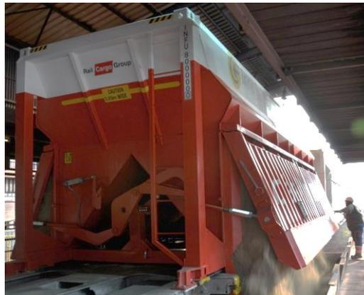
Zur Einhaltung dieses Sicherheitsabstandes ist ein Werkzeug mit entsprechend langem Stiel zu verwenden. Sein vorderes Ende ist so geformt, dass damit die Handventile an der Bedienerfront bedient werden können.
