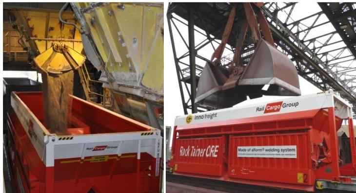
Die Ladung muss auf beide Kammern (Kammer 1 und Kammer 2) gleichmäßig verteilt werden.
