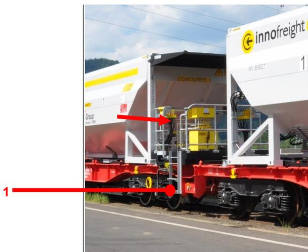
Schließen der beiden Sicherungsbügel, welche links und rechts an der Bühne angebracht sind. Es ist darauf zu achten, dass beide Bügel jeweils in der Sicherungsmulde abgelegt sind und der Sicherheitsmechanismus den Bügel in geschlossener Position blockiert, sodass er ohne Betätigen des Sicherheitsmechanismus nicht geöffnet werden kann.
