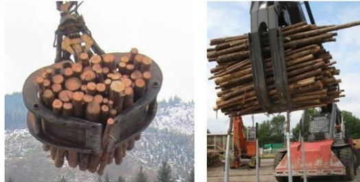
Die Entladung muss berührungs- und kollisionsfrei zwischen Ladegestell und Beladegerät/-maschine erfolgen.
