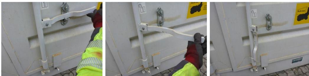
Diese beiden Schritte sind zuerst am rechten Flügel und danach in gleicher Reihenfolge am linken Flügel anzuwenden.
