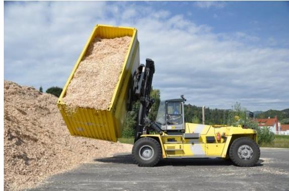
Die Drehentladung wird durch das Drehen des Containers um 360 Grad durchgeführt. Nähere Infos zur Drehentladung sind in der Betriebsanweisung für Innofreight Drehentladestapler.
