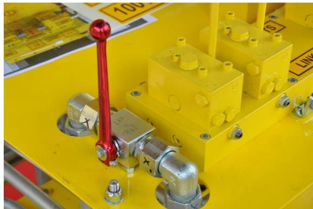
Ein Aufrichten dieses Absperrhahns ist notwendig, da dieser als Schutzmechanismus für ein unbeabsichtigtes komplettes Entladen des Hydrauliksystems dient.
