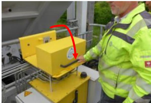
Das Vierkantschloss an der Vorderseite des Bedienpultes mit einem Vierkantschlüssel verschließen. Außerdem das Vorhängeschloss in die Lasche des Deckels des Bedienpultes einhängen und somit den Deckel zusätzlich versperren. Die Zahlenkombination für das Vorhängeschloss besteht aus den letzten vier Ziffern der Waggonnummer des Waggons auf dem sich die Bedienbühne befindet.
