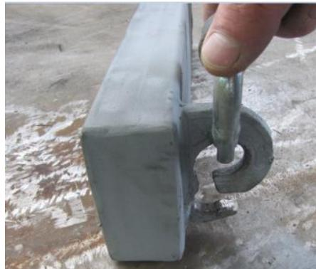
Sicherungshaken zurückklappen, sodass ein Eingriff in die Wellenverzahnung auf der Spannwinde entsteht. Danach den Spanngurt mit einem Rundrohr spannen. Dafür die vorgesehenen Steckbohrungen in der Spannwinde nutzen.
