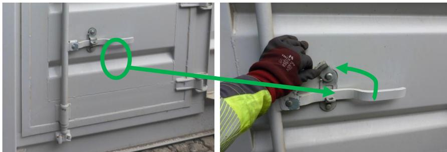
Handhebel fassen und aus der Halterung nach oben heben.
