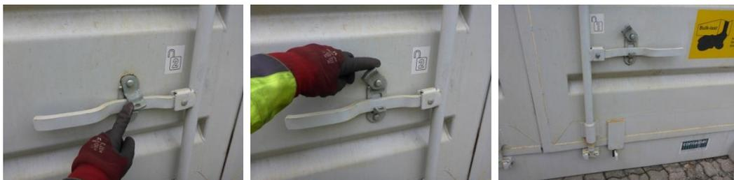
Handhebel fassen und aus der Halterung nach oben heben.
