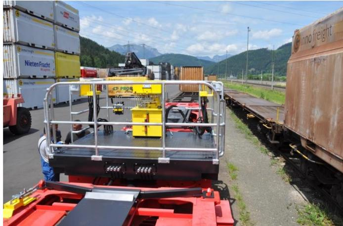
Zu diesen Elementen zählen alle hydraulischen Bedienelemente für die Entladung, deren Verwendung ist in Kapitel **Entladung** beschrieben. Die Bühne ist während der Entladung durch autorisiertes Entladepersonal besetzt. Zusätzlich befinden sich die Hydraulikleitungen samt Schnellkupplungen beziehungsweise Schraubverbindungen für die beiden RockTainer INFRA und die dazugehörigen Schotterverteilsysteme an der Bühne.
