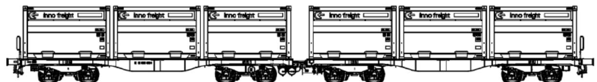
Zum Aufsetzen am InnoWaggon sind die dafür vorgesehenen 13 ft – Pins am Waggonrahmen zu benützen.
