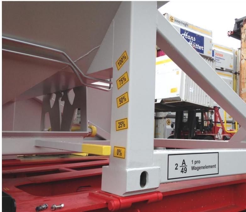
Die Beladung erfolgt von oben. Dazu wird der Waggon direkt z.B. unter einen Silo mit Förderband gefahren. Alternativ dazu kann auch eine Beladung mit z.B. Radlader erfolgen.
