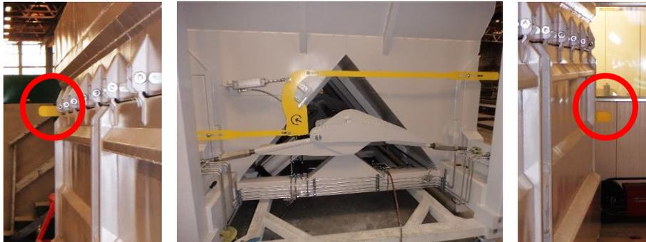
Danach von Position „SCHLIESSEN“ / „CLOSE“ direkt in Position „ÖFFNEN“ / „OPEN“ drehen. Die Klappen einer Kammer öffnen sich nun. Für die Dauer der Entladung das Werkzeug und somit das Drehschieberventil in dieser Position lassen.
