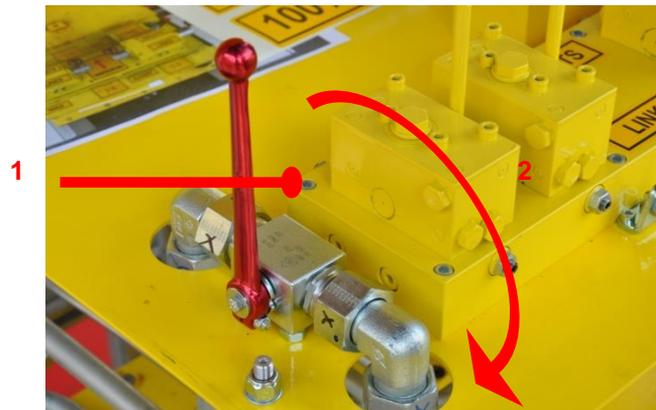
Um die letzten 25% zuzuschalten ist der Hebel in waagrechte Position zu bringen **(2)**. Dadurch werden die letzten Kapazitäten des Systems zugeschaltet, um die Entladung noch zu Ende führen zu können, beziehungsweise um nicht in den Notbetrieb wechseln zu müssen.
