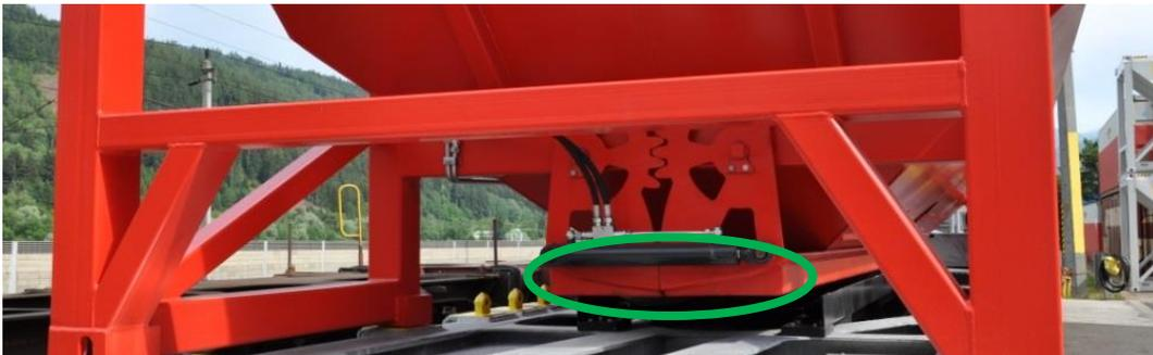
Um das zweite Entladeklappenpaar zu prüfen, ist die gegenüberliegende Stirnwand auf die gekennzeichnete Position der Entladeklappen zu prüfen.
