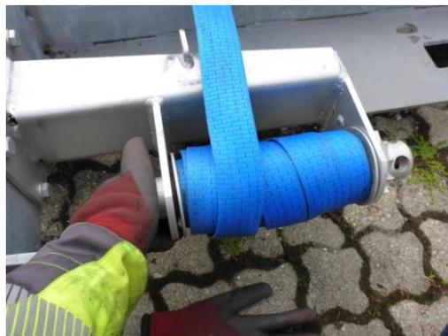
Spanngurt von Hand von der Spannwinde abrollen und Dreieckshaken aushängen und nach oben wegziehen. Dies erfolgt bei geöffnetem Sicherungshaken.
