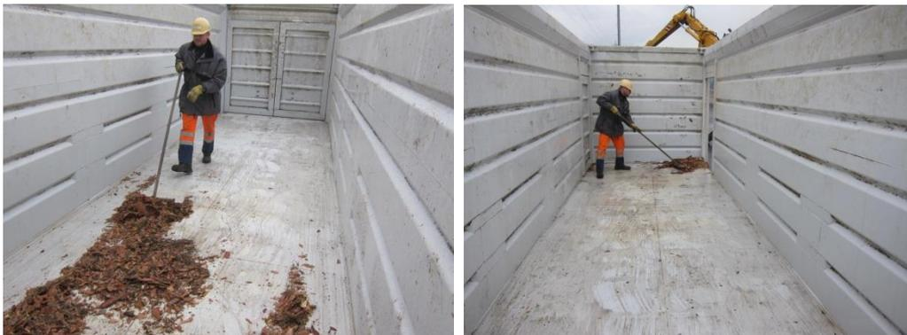
Eine Reinigung ist notwendig, wenn bei der nächsten Beladung ein unterschiedliches bzw. anderes Material geladen wird oder, wenn sich die Transportrelation und somit Absender und/oder Empfänger ändern. Eine Reinigung ist jedenfalls vorzunehmen, wenn dies durch Dritte ausdrücklich angeordnet ist.
