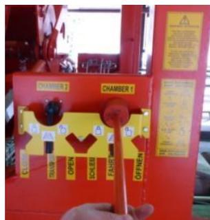
Kammer 1 und Kammer 2 sind getrennt voneinander, nacheinander zu entladen. Das bedeutet ein gleichzeitiges Öffnen beider Kammern mit der Betätigung nur eines einzigen Handventiles ist nicht möglich. Mit einem Handventil kann nur eine Kammer geöffnet werden.
