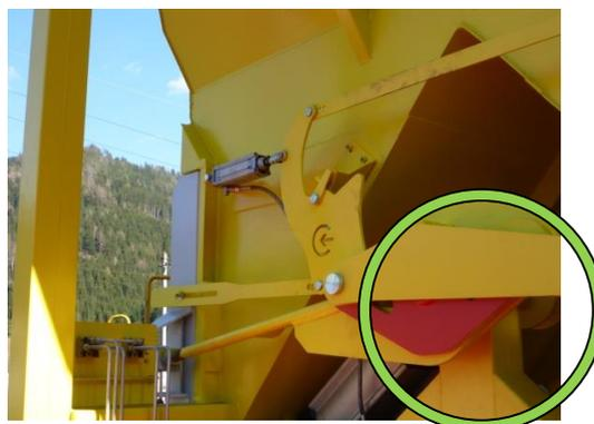
Die Beladung ist nicht komplett abgeschlossen, solange sich der Sicherungshebel in geöffneter Position befindet, die beiden Indikatoren in ihren ausgefahrenen Positionen befinden, oder die Hauptwelle nicht über die „Totpunkt-lage“ gedreht wurde.
