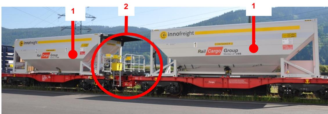
Die Bühne für den Bediener trägt alle Elemente, die zur Bedienung notwendig sind:
