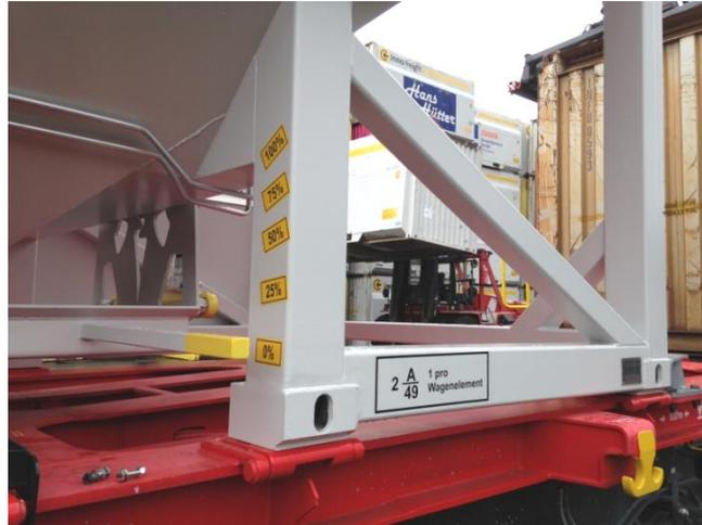
Dieser gelbe Stab, je einer pro Seite, ist bei einem Blick entlang der Längsseite von der Bedienerbühne aus sichtbar. Zur Beurteilung der Klappenstellung ist die Position des Stabes mit den gelben Fixmarkierungen am nächstgelegenen Ecksteher des Ladegestelles zu vergleichen.
