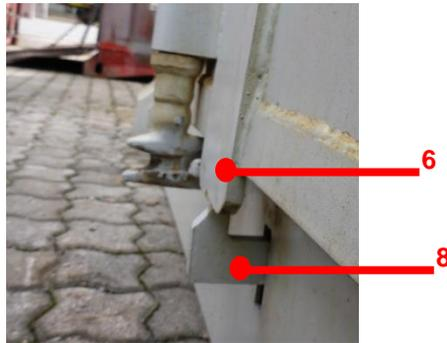
Ohne gegenseitigen Eingriff von Sicherungshaken und Lasche besteht die Gefahr, dass während bzw. nach Durchführung der nächsten Schritte die Hecktüren bzw. die Heckklappe aufgrund des Druckes von der Ladung unkontrolliert und ungebremst aufschwingen bzw. aufschwingt.
