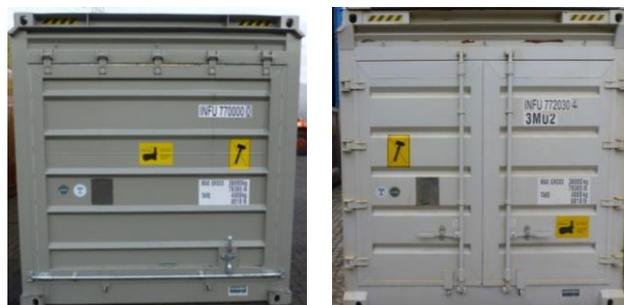
Die Heckklappe ist mit einer horizontalen Verriegelungseinheit versehen. Bei der Ausführung mit Hecktüren ist pro Türflügel eine vertikale Verriegelungseinheit verbaut. Alle verbauten Verriegelungseinheiten funktionieren nach demselben Prinzip, sodass folgende Beschreibung für beide Ausführungen anwendbar ist.
