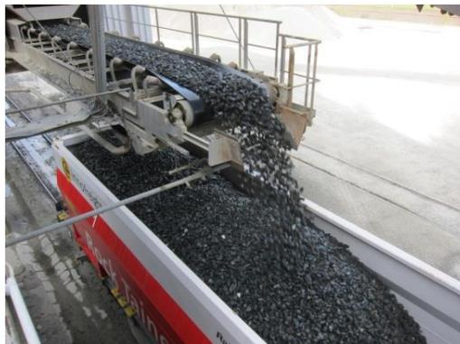
Die Beladung muss berührungs- und kollisionsfrei zwischen Ladegestell und Beladegerät/-maschine erfolgen. Das heißt, bei jeder Art der Beladung von oben oder von der Seite her, ist Kontakt zwischen Lademaschinerie (Förderband, Ausleger Radlader, ...) und Ladegestell untersagt.
