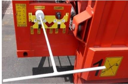
Zum Öffnen der Klappen von Kammer 1 bzw. Kammer 2 das Handventil mit der Beschriftung „CHAMBER 1“ / „KAMMER 1“ bzw. „CHAMBER 2“ / „KAMMER 2“ von Position „FAHRT“ / „TRANSPORT“ zuerst in Position „SCHLIESSEN“ / „CLOSE“ drehen.
