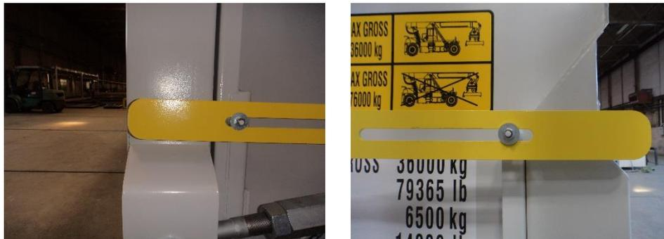
Zusätzlich dazu ist an der Hauptwelle eine Markierung in Kontrastfarbe angebracht. Diese zeigt an ob die Hauptwelle komplett gedreht und die „Totpunkt-lage“, die für die korrekte Klappenverriegelung notwendig ist, erreicht wurde. In komplett geschlossener Position ist, wie in folgendem Bild, unter dem Schergelenk nur die Markierung in Kontrastfarbe sichtbar.
