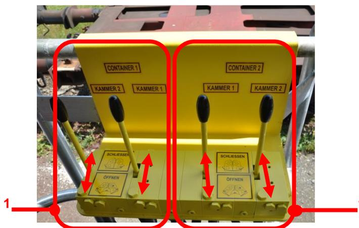
Dafür stehen zwei Hebelpaare (1) zur Verfügung, somit ein Hebelpaar pro Ladegestell. Jeder Hebel dient zum Öffnen und Schließen einer der beiden Ladekammern pro Ladegestell.
