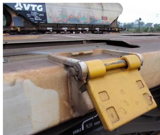
Bild 7.5: weggeklappter Aufsetzzapfen
