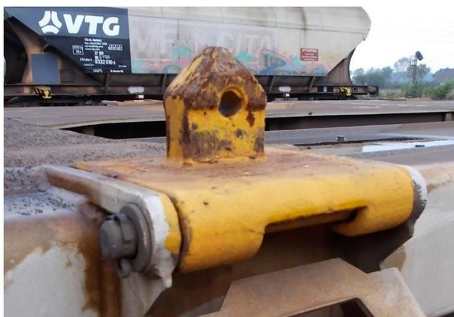
Bild 7.4: hochgeklappter Aufsetzzapfen
