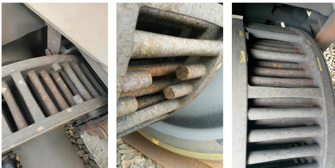
Bilder 6.5 bis 6.7: Wegen Auswuchten gekürzte oder entfernte Kühlrippen.
