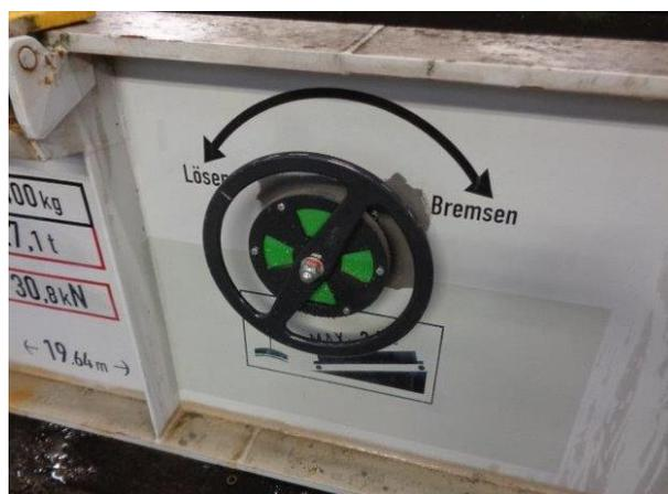
Bild 5.20: Bremsfunktionsanzeige am Handrad
