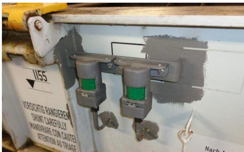
Bild 5.19: Bremsfunktionsanzeige des Herstellers Faiveley Transport
