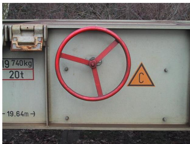
Bild 5.10: Handrad der Feststellbremse am Untergestell
