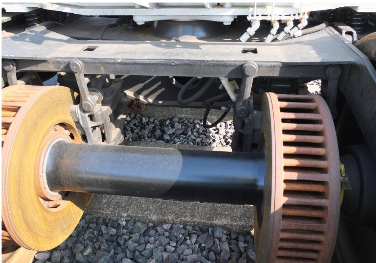
Bild 6.1: Radsatzwelle mit Bremscheiben und Bremsgestängen
