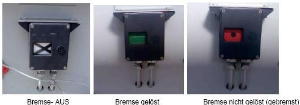
Bild 5.16 Einzelanzeigevorrichtungen
