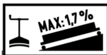
Bild 5.12: Gefälle Feststellbremse
