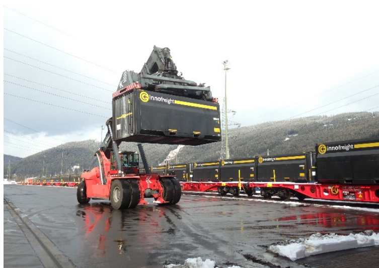
Abbildung 7 Anheben mittels Reachstacker
