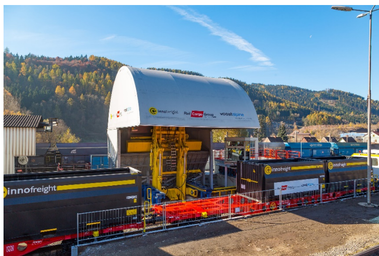
Abbildung 12 Entladung mittels stationärer Entladeanlage
