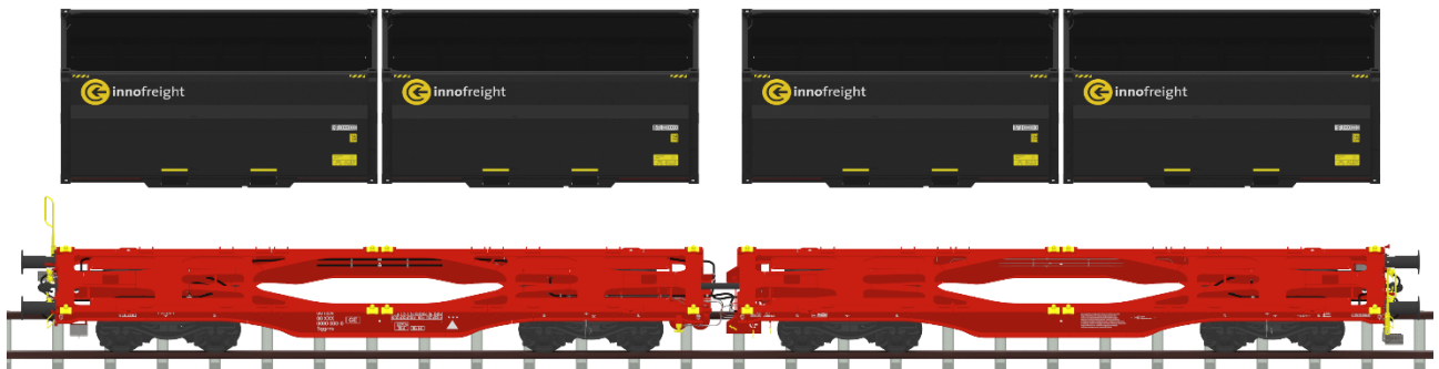
Abbildung 8 Positionierung IW 80ft - Ansicht 1
