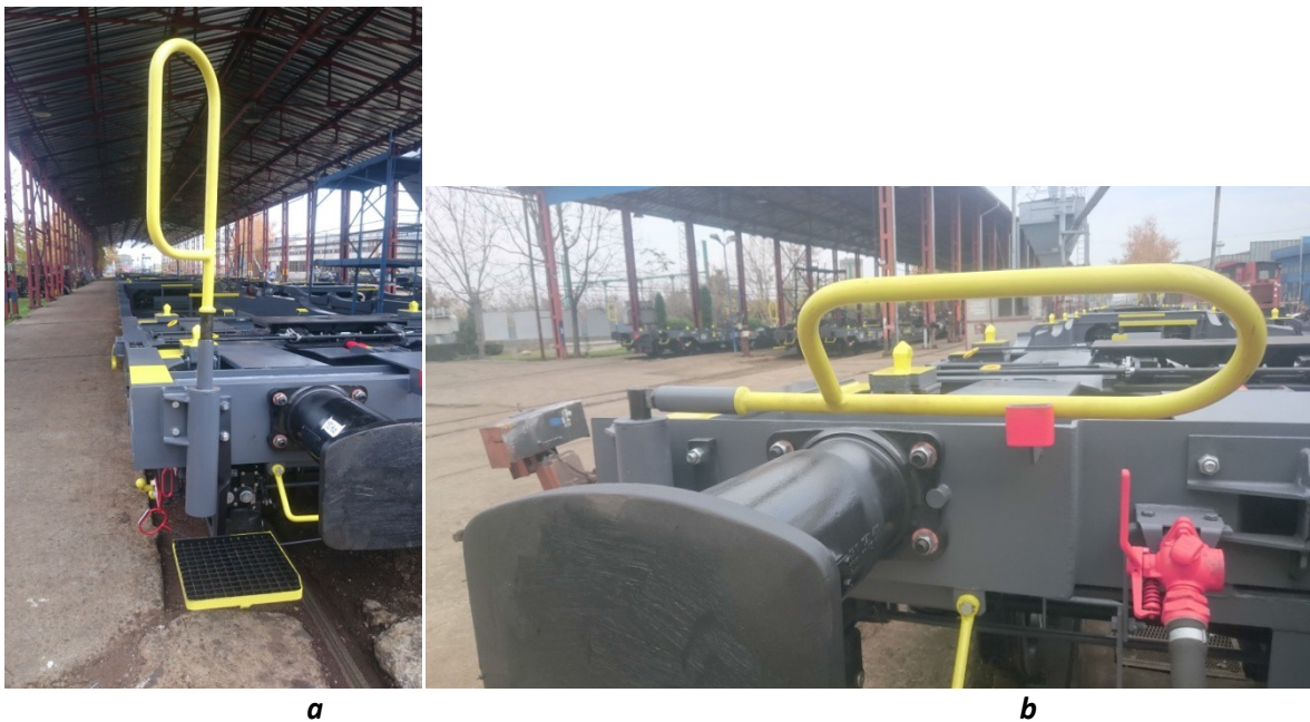
Abb.9 Rangierhandgriff: a - in Arbeitsstellung; b - in zusammengeklappter Position
