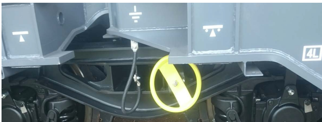
Abb. 6. Position vom Handbremsrad
