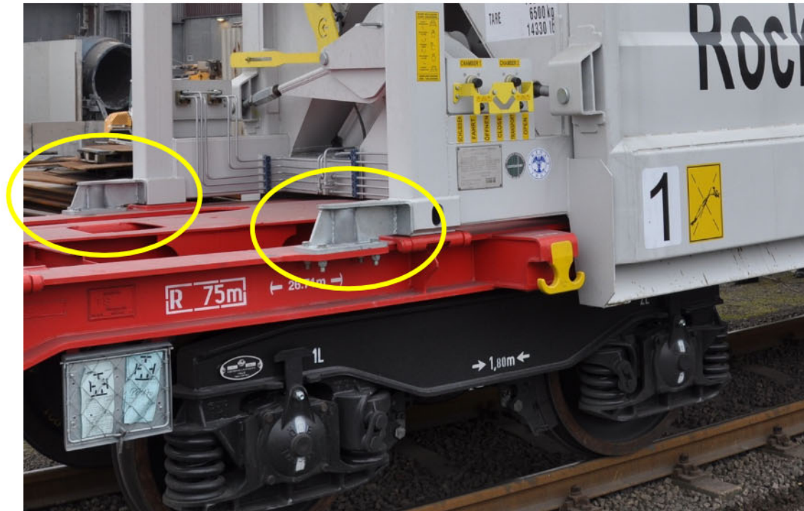
Abbildung 9 Anschlagkonsolen (Stopper-Konsole) im Einsatz
