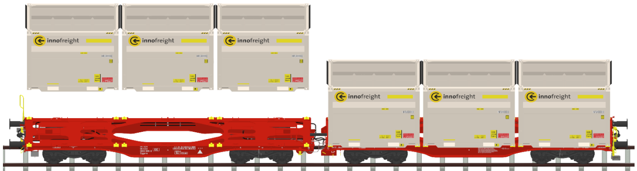
Abbildung 7 Positionierung IW 80ft - Ansicht 2
