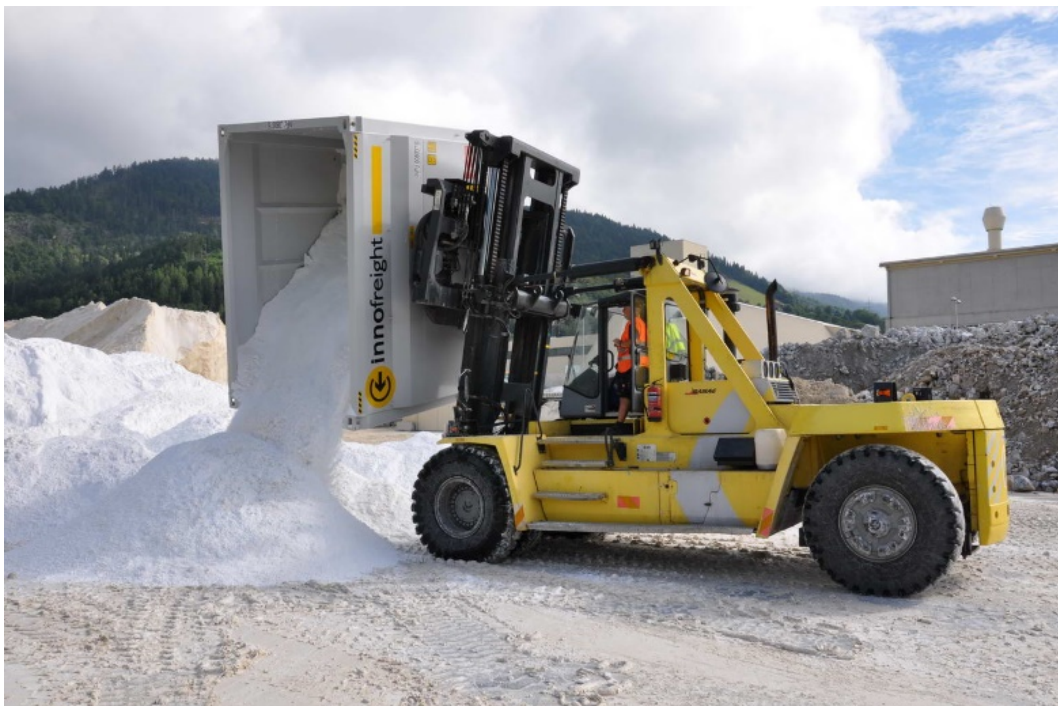
Abbildung 11 Entladung WoodTainer XXM
