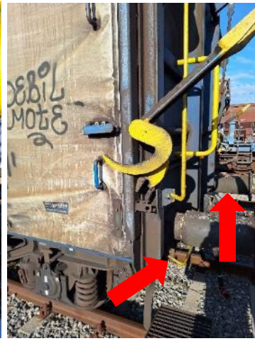
Betätigungshebel bis zur Endposition nach oben drücken.
