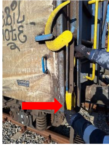
Betätigungshebel bis zur Endposition nach oben drücken.
