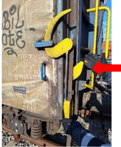
Die Sicherungsfalle des Betätigungshebels entriegeln.
