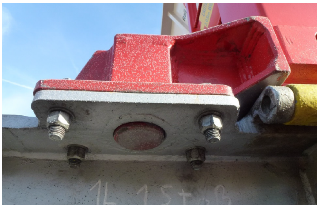
Abbildung 9 Anschlagkonsole – Schraubverbindung mit Waggon
