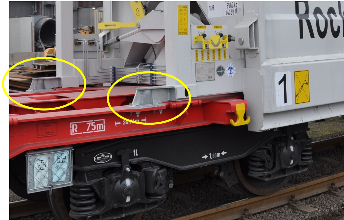
Abbildung 8 Anschlagkonsolen (Stopper-Konsole) im Einsatz
